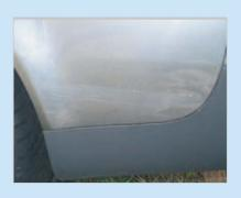
Kratzer, die länger als 10 cm oder an einem Bauteil mehrfach vorhanden sind. Außerdem alle Kratzer, die nicht durch Polieren zu entfernen sind und eine Lackierung erforderlich machen.
